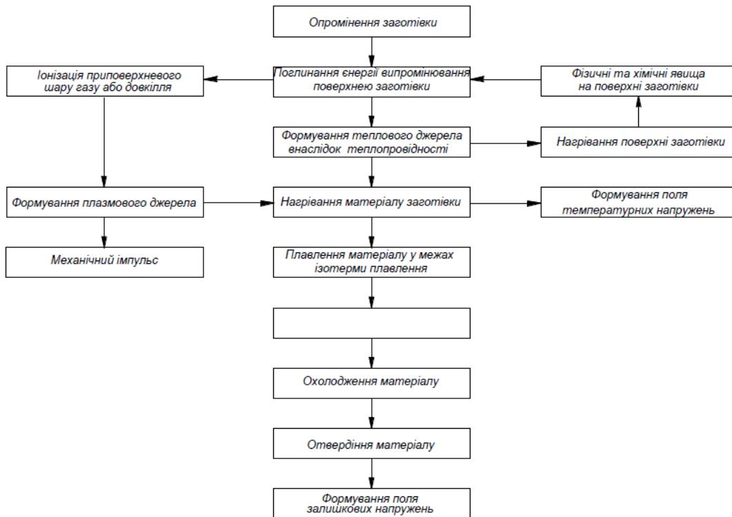
13. Який етап теплового процесу, що реалізується під час опромінення заготовки, пропущене на схемі?
