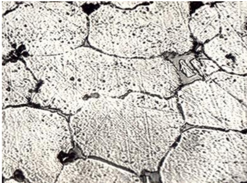
Мікроструктура деформованого відпаленого Дуралюмінію Д1, x150
