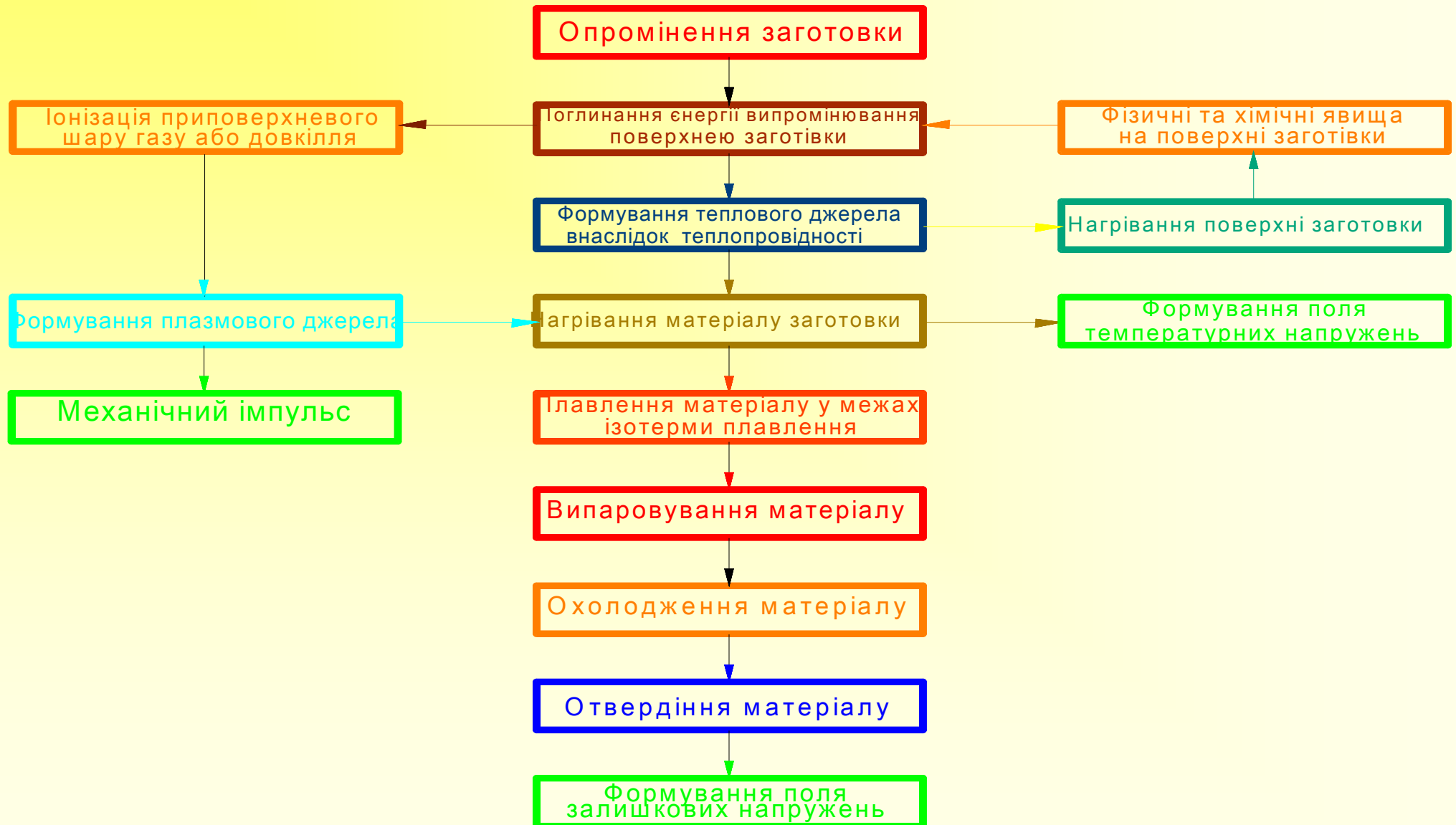
Рис. 2.1. Етапи діяння лазерного випромінювання на металеву заготовку.
