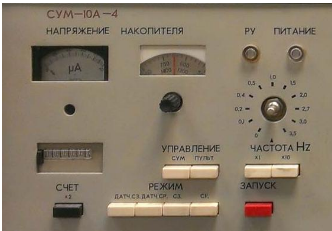
Рис 2. Система керування модулятора установки «Квант-15»
